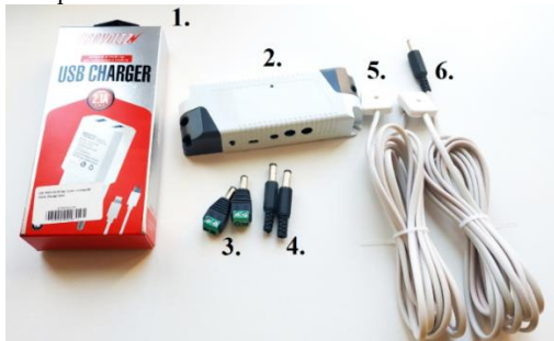
Рис. 1. Базовый комплект поставки устройства TUYA WIFI (может меняться в зависимости от заказа)
